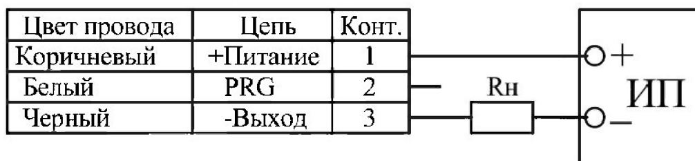
Соответствие назначения выводов разъема цветовой маркировке проводов кабеля (исполнения 91, 92 по таблице А.10)
