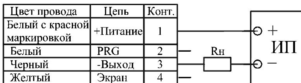
Соответствие назначения выводов разъема проводам экранированного кабеля преобразователей гидростатического давления (исполнение 90 по таблице А.10)
