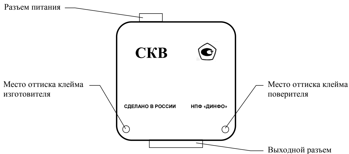
Рисунок 2 – Схема нанесения оттисков клейма на измерительный блок
